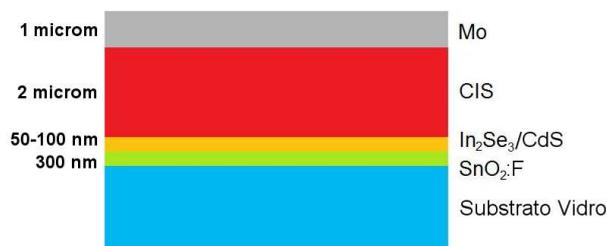
FIGURA 3.1 – Arquitetura proposta para o dispositivo fotovoltaico.
