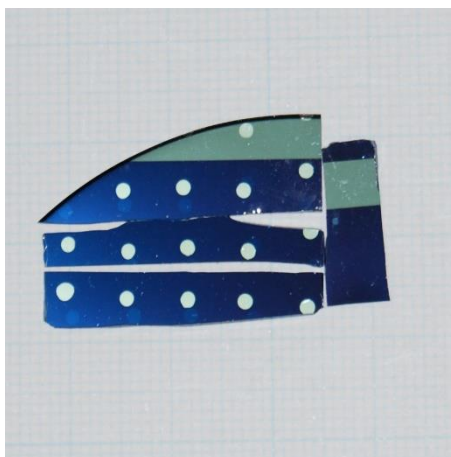
Figura 5.35: Amostra de Al 2 O 3 produzida por IBAD sob uma tensão de 800 eV. Sua espessura é de 100 nm.
