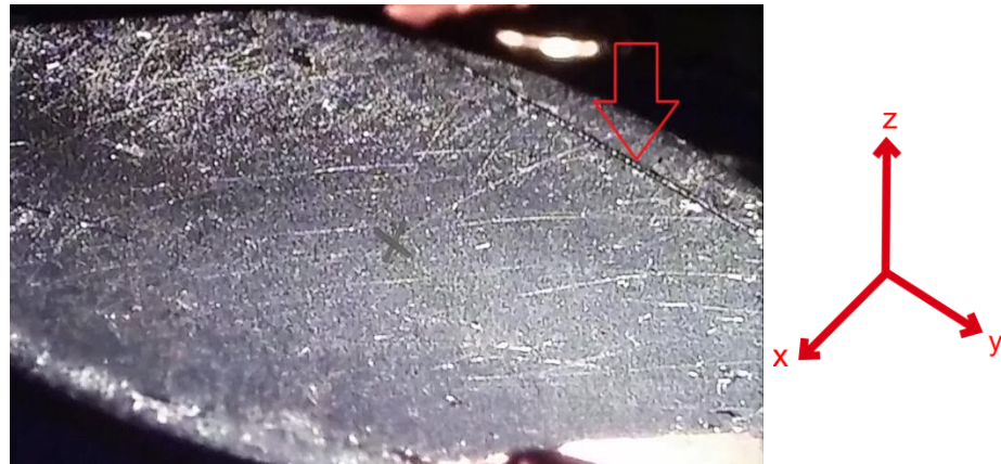
Figura 5.1: Foto da imagem da amostra de alumínio monocristalino (Al_001) feito pela câmera do espectrômetro KRATOS dentro da câmara de análise XPS. A marca X no centro da imagem aponta o alvo da incidência dos raios-X. O rasgo indicado pela seta vermelha indica interseção do plano [011] com a superfície da amostra.
