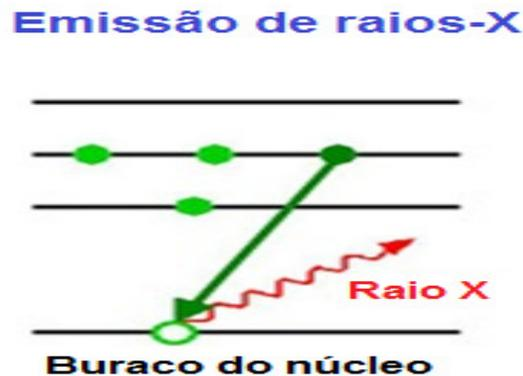
Figura 49 – Esquema do processo de emissão de raios-X característico em um átomo.
