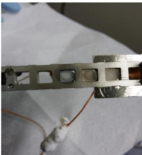
Figura 27 Porta amostra usado para fazer a degradação.
