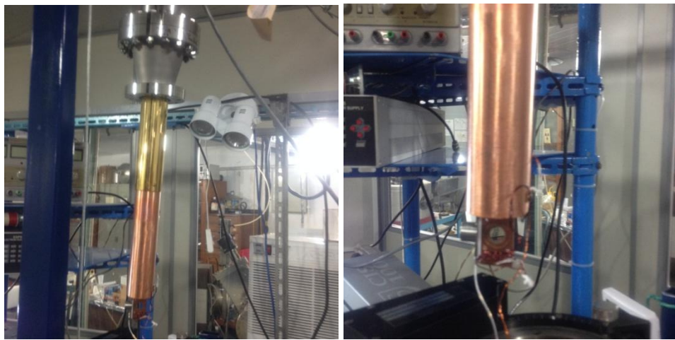
Figura 12: A esquerda o corpo do criostato e a direita o porta amostra acoplado ao criostato.
