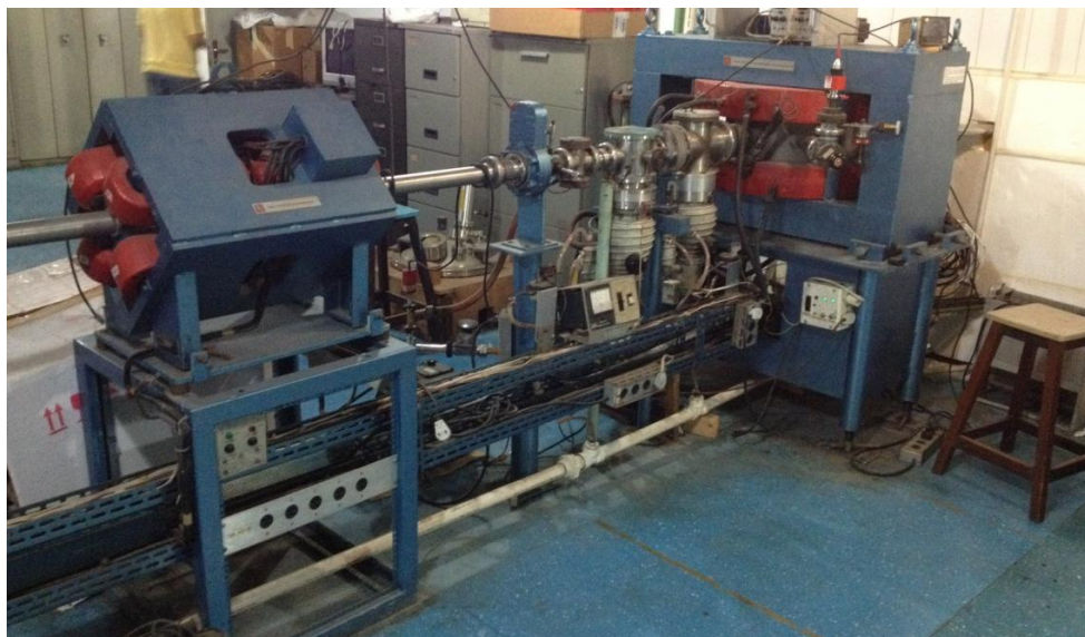
Figura 10: (a) Acelerador Vandergraf; (b) ímã analisador de 90° para seleção de carga e de momentum do íon acelerado; (c) Linha FTIR com o quadrupolo.
