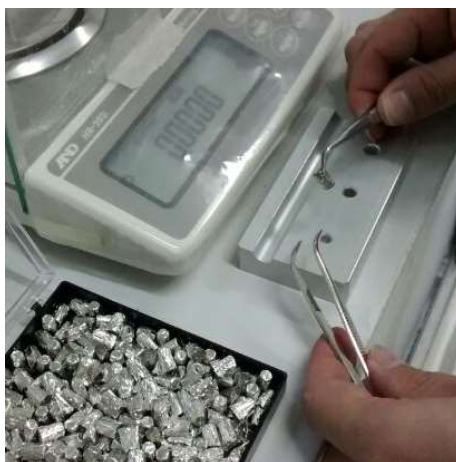
Figura 19: Amostras sendo pesadas e empacotadas em capsulas de estanho
