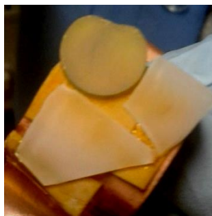
Figura 3.4: Filmes de prolina em janela de Seleneto de Zinco e em lâminas de vidro para microscopia produzidos em testes
