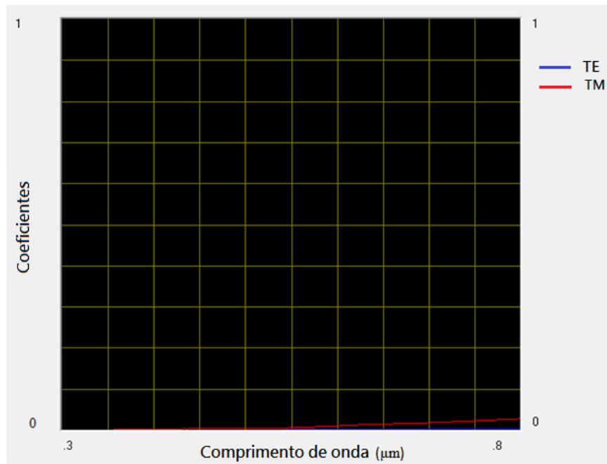
FIGURA 6.178 - Interface gráfica via programa Elipsometria do espectro de transmissão da amostra Mo para uma medida realizada em um ângulo de 55°, na região 0,3 – 0,8 µm. As siglas TE e TM representam o modo de propagação transversais do campo magnético e elétrico, respectivamente, à direção de propagação.
