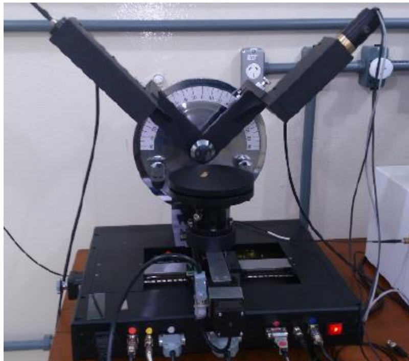
FIGURA 5.2 - Ilustração do PHE-102 Spectroscopic Ellipsometer da Angstrom Advanced (Imagem registrada no LAMUME-UFBA).
