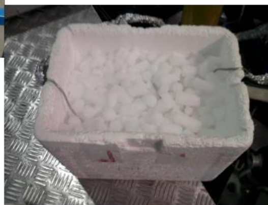
Figura 3.1: Montagem experimental utilizada para produção do formaldeído, com o detalhe da armadilha de gelo seco.
