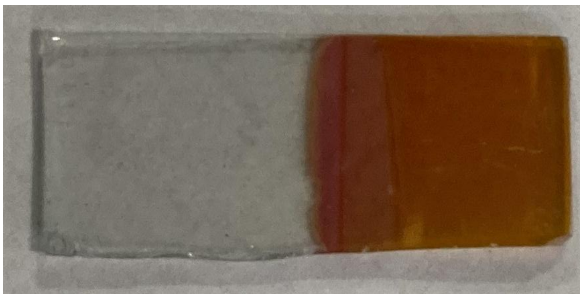
Figura 15 – Amostra de IS preparada por eletrodeposição. Fonte: Ribeiro, 2018.
