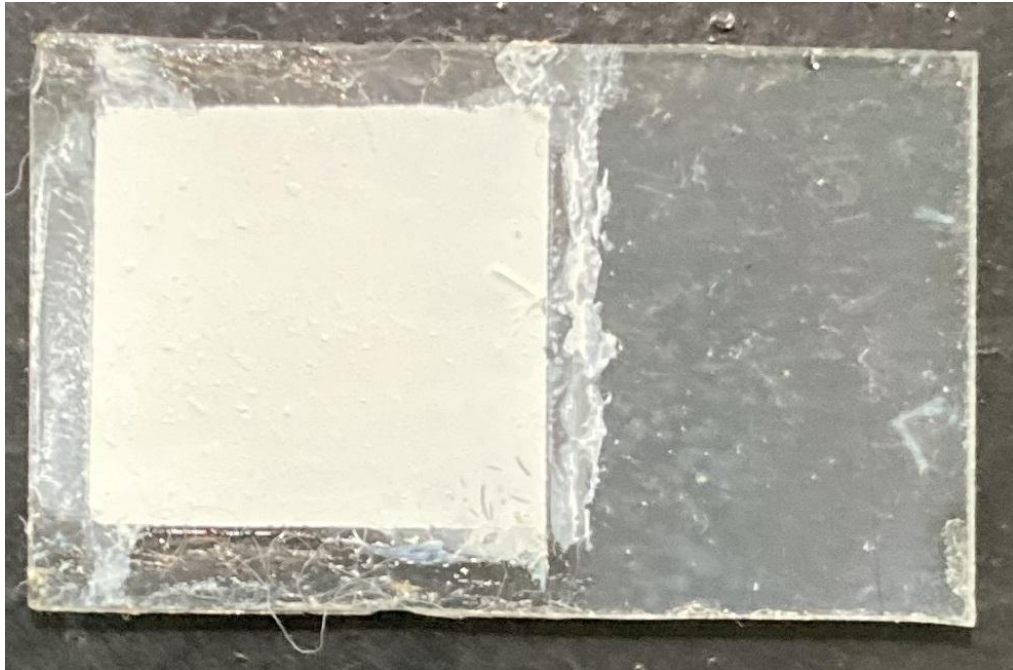
Figura 9 – Amostra de TiO 2 preparada pelo método do Doctor-blade. Fonte: Ferreira, 2017.
