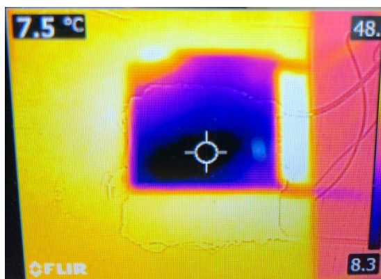
Figura 20 - Foto tirada da câmera térmica para observação da homogeneidade da temperatura na célula Peltier. Fonte: Produzido pelo autor.
