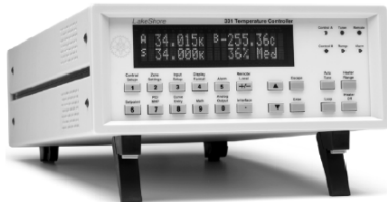
Figura 3.8: Controlador de temperatura da Lakeshore, modelo 331S, utilizado na operação do criostato.
