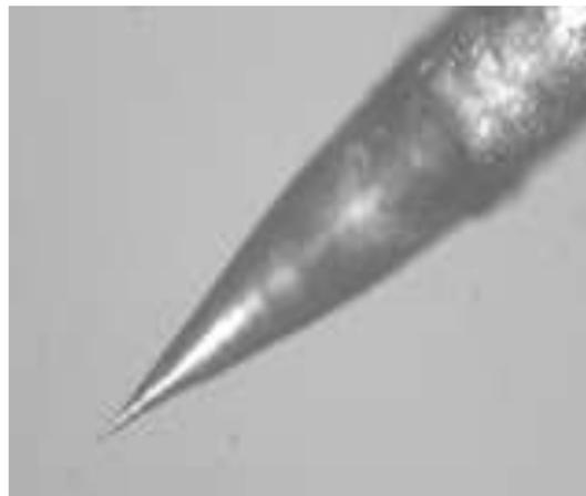
Figura 2.4: Imagem ampliada de uma ponta de íridio observada com um microscópio ótico, após um novo processo de erosão eletroquímica. Figura extraída da referência [2].
