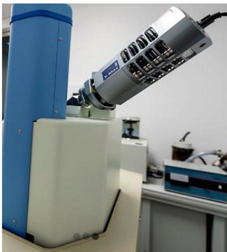
**Figura 10:** Aparelho EDS da JEOL 6610LV disponível no Laboratório Multiusuário de Microscopia Eletrônica – LAMUME [15].
