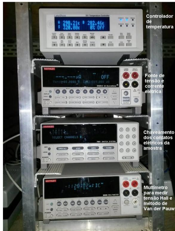
**Figura 5.5-** Equipamento do sistema de aquisição interligado via interface GPIB.
