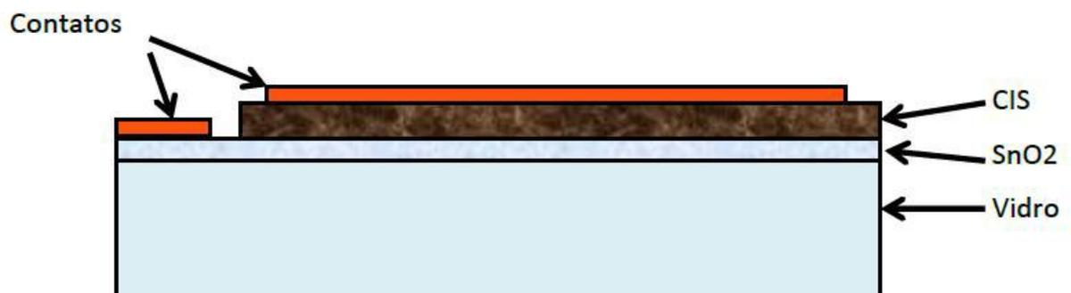
**Figura 1.1** - Estrutura de um painel solar plano com filme fino com janela seletiva de  $\text{SnO}_2$ . Fig. adaptada de [1.1].
