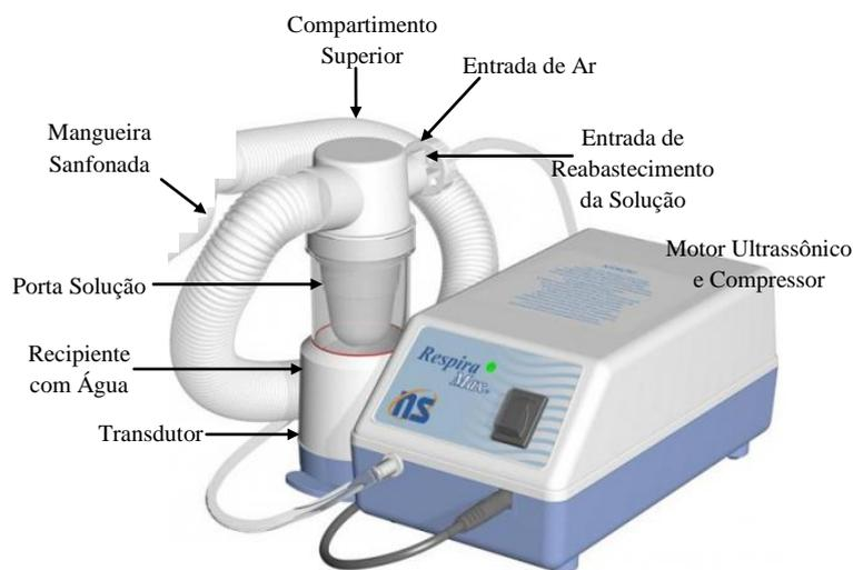
Figura 13: Componentes do nebulizador.
