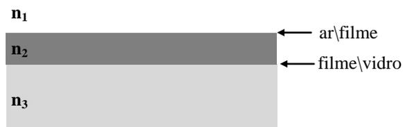
Figura 11: Diagrama de um filme fino de SnO<sub>2</sub> sob substrato de vidro, mostrando interfaces.
