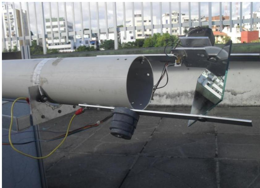
**Figura 54:** Foto do acoplamento do espelho com o tubo
