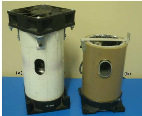
Figura 2.7: Fontes de radiação infravermelha. Legenda da figura: a) Montagem para lâmpada de filamento, tipo H4; b) Montagem para o resistor de  $15\Omega$  e  $15W$ .
