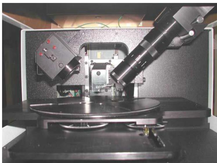
Figura 4.5: Perfilômetro Dektak<sup>3</sup>ST.
