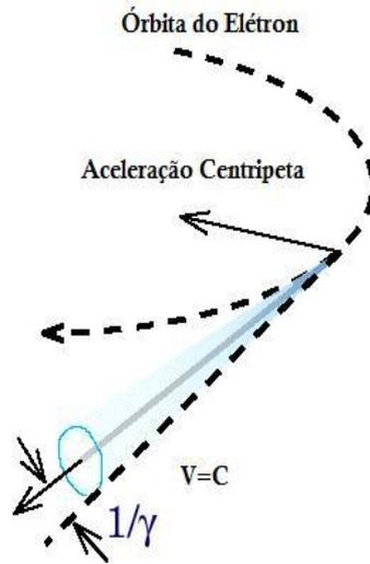
Figura 2.3: Emissão de um elétron em uma órbita circular.
