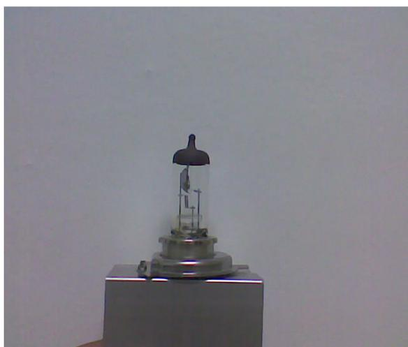
**Figura 16:** Lâmpada H4 utilizada no espectrômetro.
