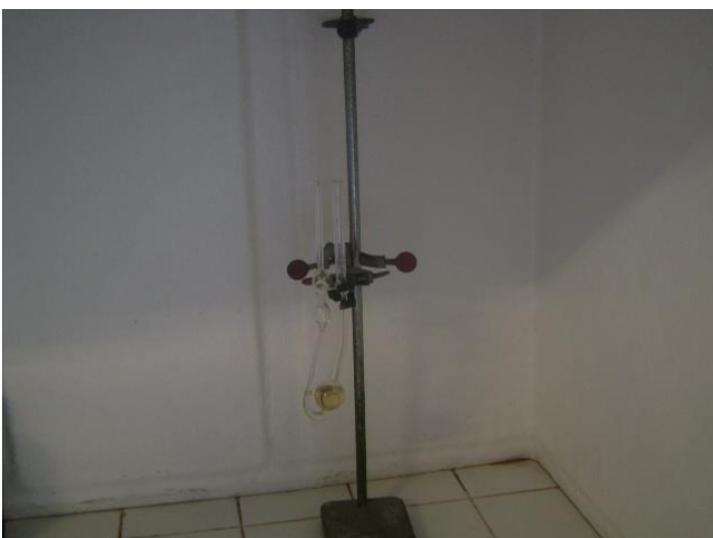
**Figura 4.3a: Viscosímetro capilar de Ostwald Quimex, A 25, 500**
