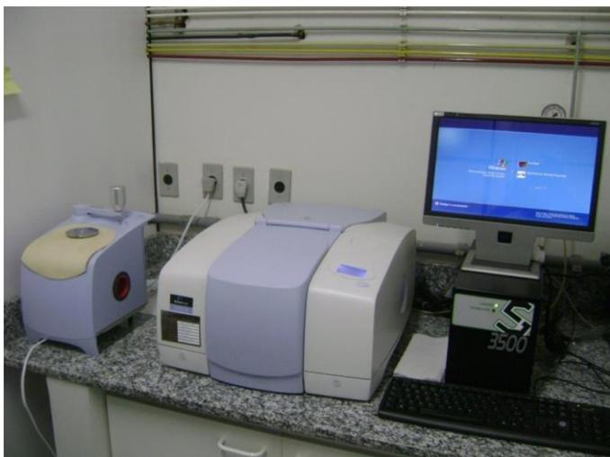
**Figura 4.5: Espectrômetro (FTIR)- Perkin Elmer, modelo Sprettrum One**
