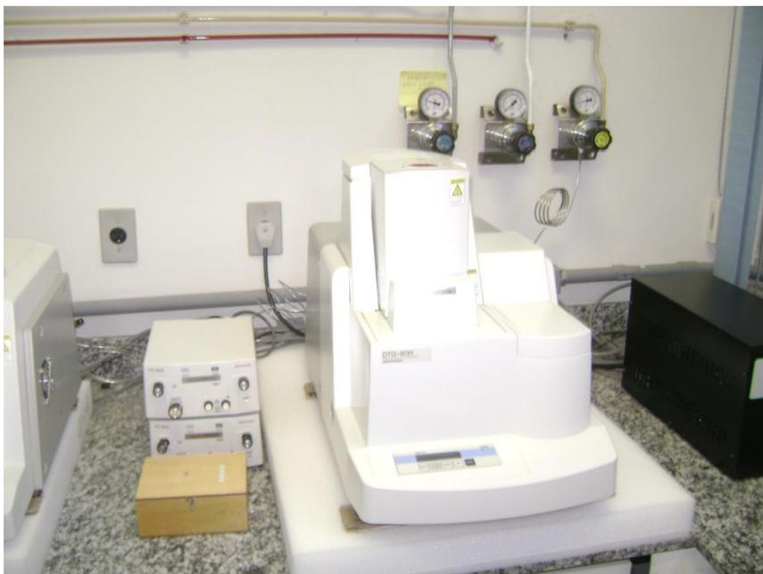
**Figura 4.4a: Equipamento Metler Toledo TG/DTA 50**
