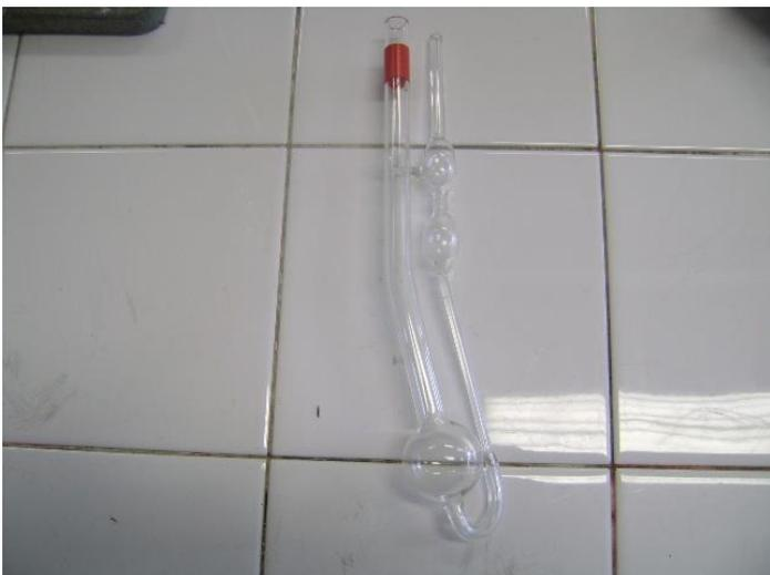
**Figura 4.3b: Viscosímetro capilar de Ostwald Quimex, A 25, 500**
