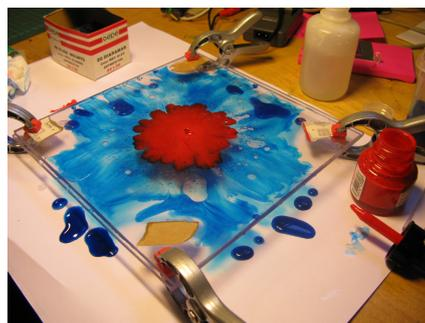
(b) Aparato da célula de Hele-Shaw, com injeção no centro e em uma direção perpendicular ao plano das placas.
